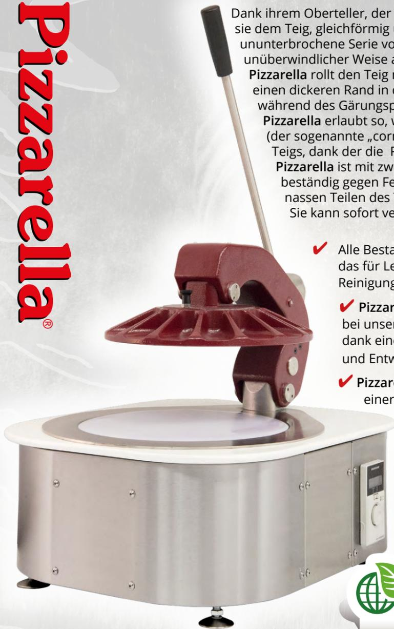
Dank ihrem Oberteller, der manuell vom Operator betätigt wird, überträgt sie dem Teig, gleichförmig und zart, durch besondere Antihafmembranen, ununterbrochene Serie von Wellen und Drehpulsationen, die ihn auf unüberwindlicher Weise ausrollen.
